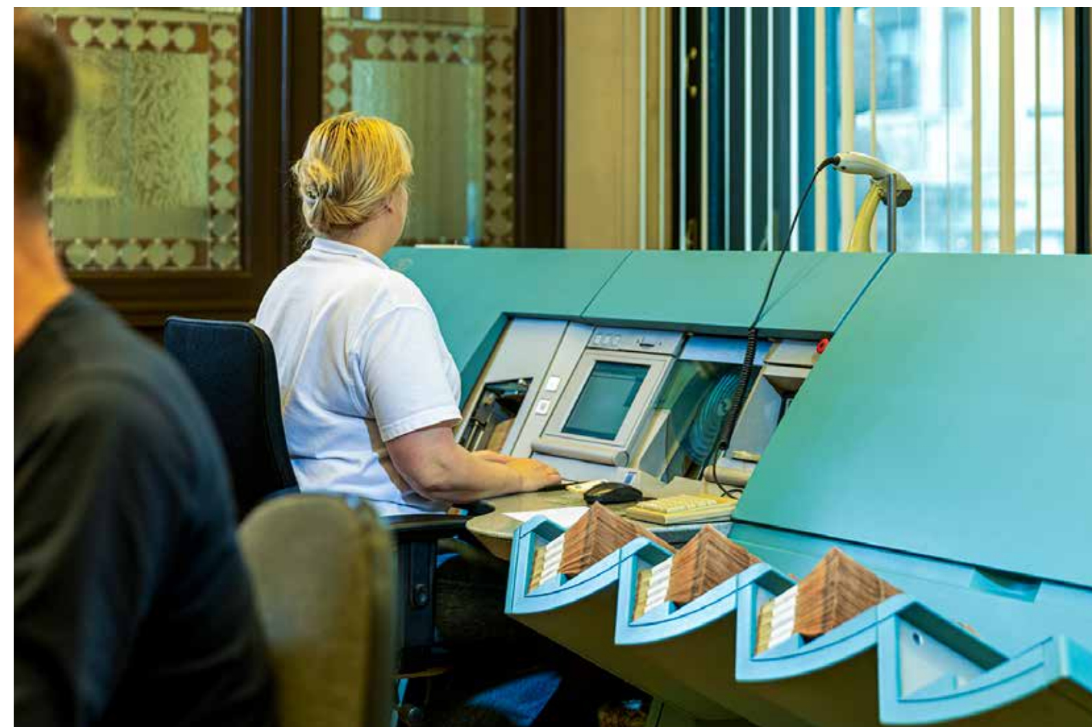
Automatizuota banknotų apdorojimo sistema BPS 1000 per minutę gali sutvarkyti iki 1 800 banknotų.
